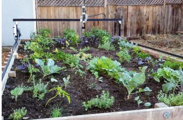
Die Unterkonstruktion einer Agri-PV-Anlage bietet verschiedene Möglichkeiten, um Synergien zwischen elektrischer und landwirtschaftlicher Ebene zu nutzen. So kann beispielsweise eine CNC-gesteuerte vollautomatische Feldbearbeitung in das Agri-PV-System integriert werden, welches sich auf Schienen an der Unterkonstruktion über den Acker bewegt. Um diese Möglichkeiten zu erproben haben wir auf dem Gelände des Fraunhofer ISE einen kleinen Demonstrator der Open-Source-Bewegung „FarmBot“ aufgestellt.
